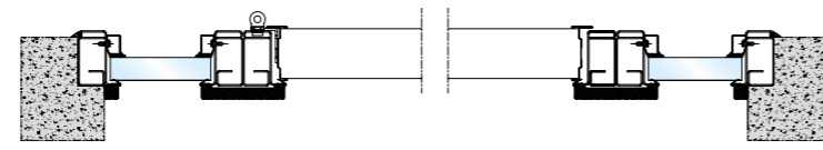
SEZIONE ORIZZONTALE ANTA CON DUE FIANCHI LUCE Horizontal section of a leaf with two side glasses
